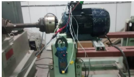
Figura 3 - Salida de las termocuplas al multimetedor
