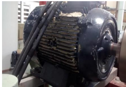
Figura 5 - Detalle del 50% de los álabes tapados
