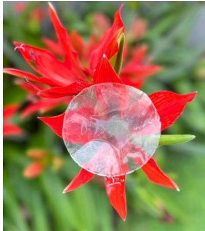
Figura 1: La imagen muestra la transparencia de la película final, determinada por la proporción de pectina utilizada.
