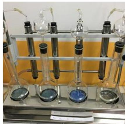
Figura 3: Destilación de muestra digerida
